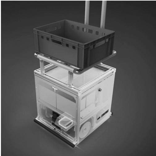
写真8 センサのAGV底面への搭載イメージ
